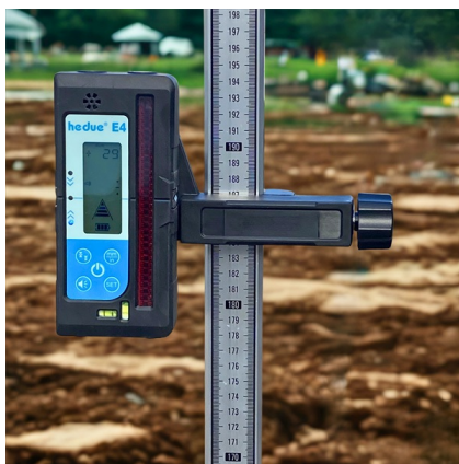
El receptor láser digital muestra la diferencia de altura respecto a la línea láser en mm o pulgadas.
