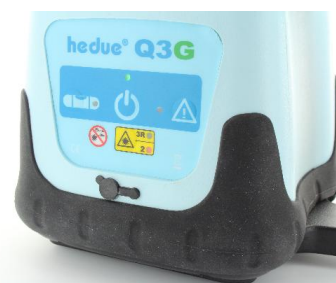
Laserklasse umschaltbar zwischen Klasse II und 3R.
