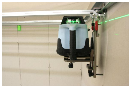
Melhor visualização da linha laser dentro de casa devido ao diodo laser verde.
