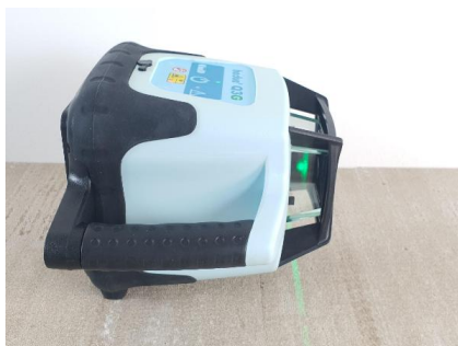
Autonivelación horizontal y vertical mediante servomotores hasta 5° de inclinación.
