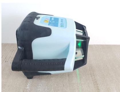
Horizontale en verticale zelfnivellering door servomotoren tot 5° helling.
