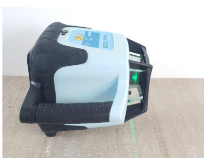
Autolivellamento orizzontale e verticale con servomotori fino a 5° di inclinazione.
