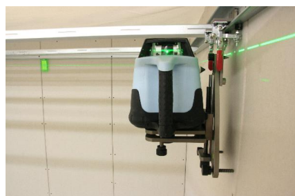
Migliore visualizzazione della linea laser all'interno grazie al diodo laser verde.
