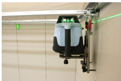
Vizibilitate a razei laser sporită în spații interioare datorită diodei cu lumină verde.
