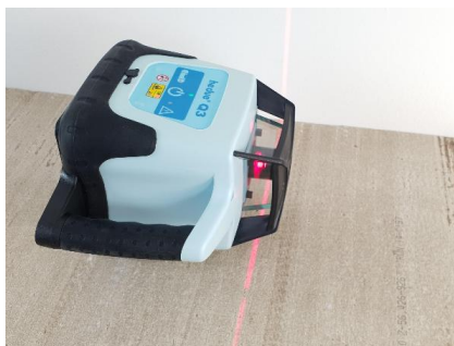
Horizontale und vertikale Selbstnivellierung durch Stellmotoren bis 5° Schräge.
