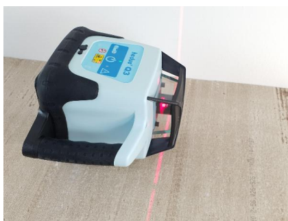
Autonivelación horizontal y vertical mediante servomotores hasta 5° de inclinación.
