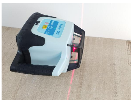
Samoczynne poziomowanie poziome i pionowe przy użyciu serwonapędów o nachyleniu do 5°.
