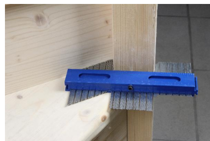
Einfaches Abtasten von komplexen Konturen
