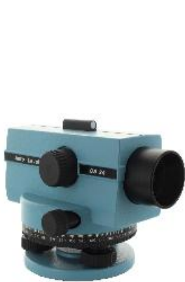
Automatisches Ausrichten in der Horizontalen durch Pendel-Kompensator.
