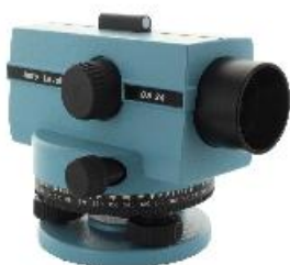
Alignement automatique dans le plan horizontal au moyen d'un compensateur de pendule.
