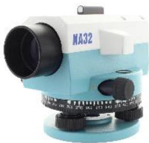
**Automatisches Ausrichten in der Horizontalen durch Pendel-Kompensator.**
