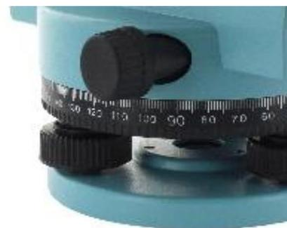
**Puntamento rapido ed esatto con l'azionamento laterale fine.**
