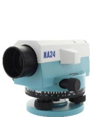
Automatische uitlijning in het horizontale vlak door middel van een pendelcompensator.
