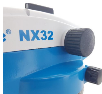
Țintire rapidă și precisă cu ajutorul reglajului fin lateral.
