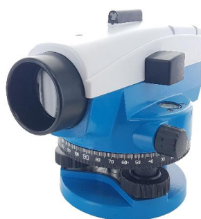
Łatwy odczyt z 32-krotnym powiększeniem.
