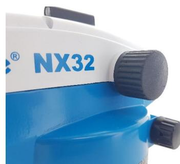
**Apontamento rápido e exato com o acionamento lateral fino.**
