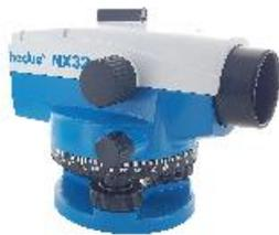
**Alignement horizontal automatique avec le compensateur magnétique amorti.**
