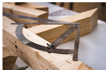
Con fori per il tracciamento
