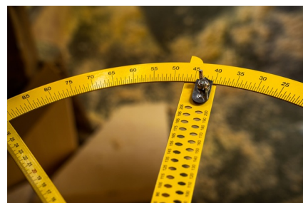
Con fori per il tracciamento
