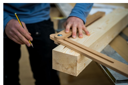
Avec trou oblong dans la languette
