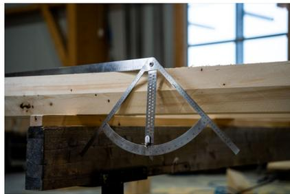
L'Équerre Alpha peut être utilisée pour tous les types d'assemblage.
