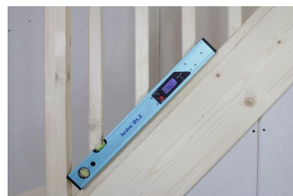
Mesure les pentes en degrés, en pourcentage, en millimètres par mètre ou en pouces par pied
