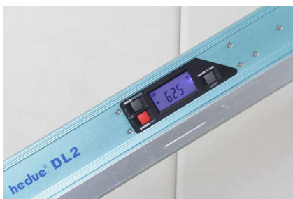
Visor de fácil leitura que gira automaticamente durante as medições aéreas
