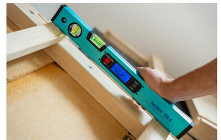
Display di facile lettura che ruota automaticamente durante le misurazioni in alto
