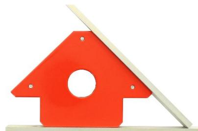
Utilizzo versatile per il fissaggio dei pezzi
