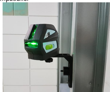
Collegamento di tutti i comuni treppiedi e supporti con l'adattatore magnetico multifunzione.
