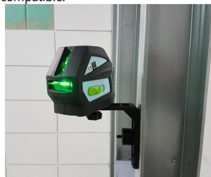
**Conexión de todos los trípodes y soportes habituales con el adaptador magnético multifunción.**
