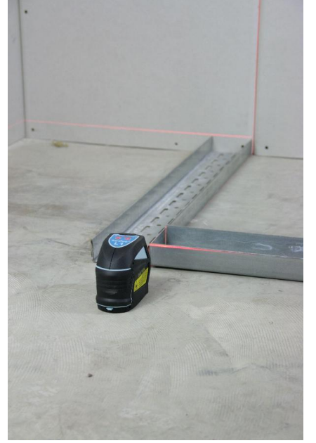
Manyetik sönümlü sarkaç ile hızlı ve tam otomatik tesviye.
