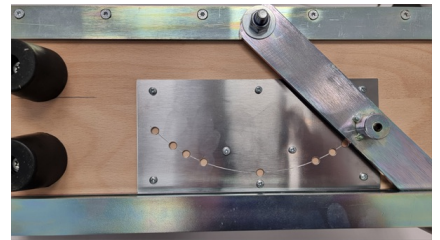
Präzise Winkelrastung auf der Unterseite
