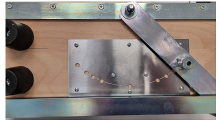
Nauwkeurige hoekvergrendeling aan de onderkant
