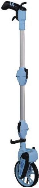
Betrouwbare aandrijving van de meter via een tandwielstang.
