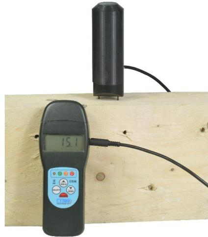
**Anschlussfertig für das Feuchtigkeitsmessgerät hedue C036**
