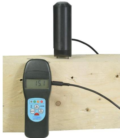
**Pronto para ligação ao medidor de umidade hedue C036**
