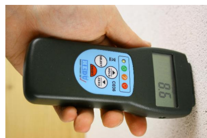
Determinação do teor de humidade da madeira e dos materiais de construção em segundos
