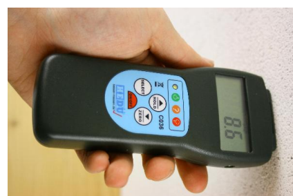
Determinazione del contenuto di umidità del legno e dei materiali da costruzione in pochi secondi
