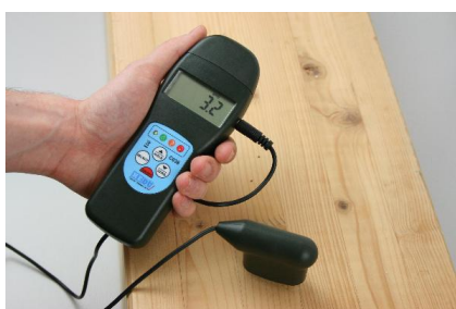
Adatto per legno e materiali da costruzione tra 200 e 3000 kg/m 3 .
