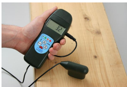
Adecuado para madera y materiales de construcción entre 200 y 3000 kg/m³.
