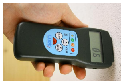
Określenie zawartości wilgoci w drewnie i materiałach budowlanych w ciągu kilku sekund
