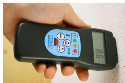
Détermination de la teneur en humidité du bois et des matériaux de construction en quelques secondes
