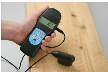
Convient pour le bois et les matériaux de construction entre 200 et 3000 kg/m<sup>3</sup>.
