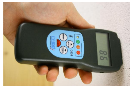
Stabilire a conținutului de umiditate din lemn și materiale de construcții în câteva secunde
