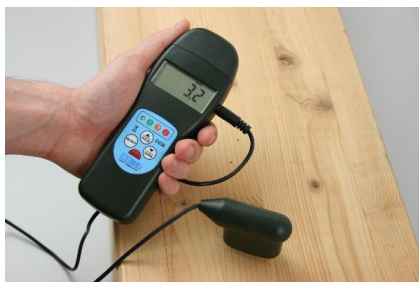
Potrivit pentru materiale lemnoase și de construcție ce au între 200 și 3000 kg/m 3
