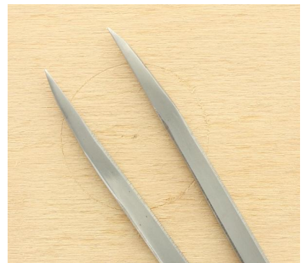
Mit gehärteten Spitzen zum Anreißen
