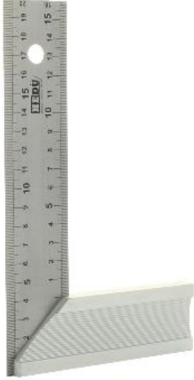
Sertleştirilmiş paslanmaz çelikten yapılmış çelik dil
