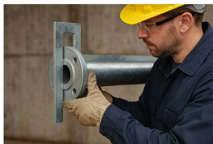
Exaktes Ausrichten von Flanschplatten am Rohrende.
