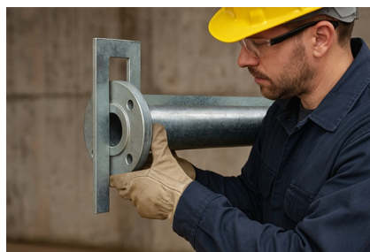
Exaktes Ausrichten von Flanschplatten am Rohrende.
