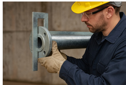
Exaktes Ausrichten von Flanschplatten am Rohrende.
