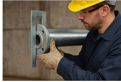
Exaktes Ausrichten von Flanschplatten am Rohrende.
