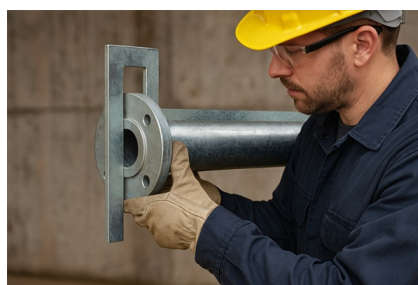
Exaktes Ausrichten von Flanschplatten am Rohrende.
