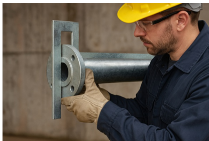
Exaktes Ausrichten von Flanschplatten am Rohrende.
